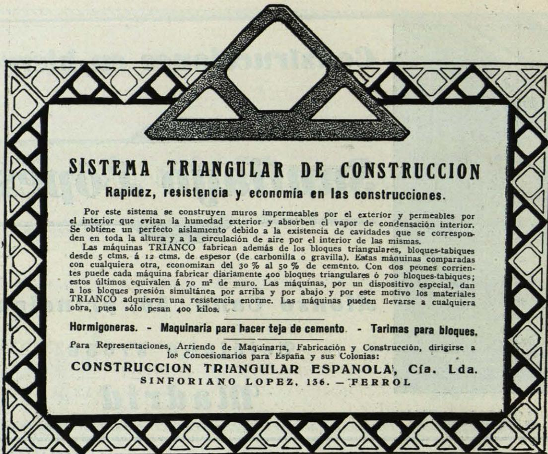
**SISTEMA TRIANGULAR DE CONSTRUCCION**
