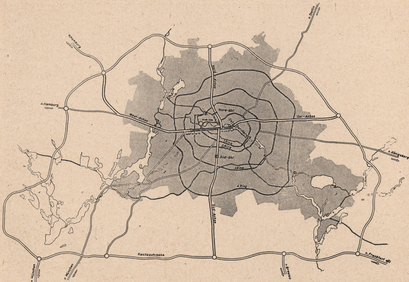
Esquema del sistema de ejes y anillos aprobado como base de las reformas de Berlín.
