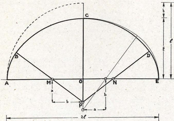
Figura 2ª.—Trazado del arco campanel de tres centros.
