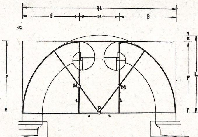
Figura 3ª.—Trazado del arco de las dos volutas.
