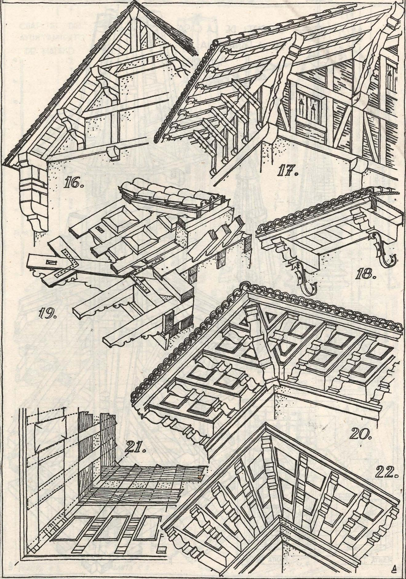
A uno de estos anillos acometen los pares de limatesa de la cubierta en pabellón. Los demás pares de esta cubierta acometen igualmente a espera a ese anillo, o se embrochalan a los anteriores.
