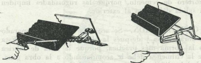
En las figuras se aprecian los dos procedimientos para regular el paso de humo por la garganta: o por giro actuando sobre el avance de un tornillo o empujando hacia delante la guía mediante un gancho.
