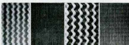
Cartones para embalar, proyectados por George Collet, que se adaptan perfectamente a la forma del objeto a embalar.
