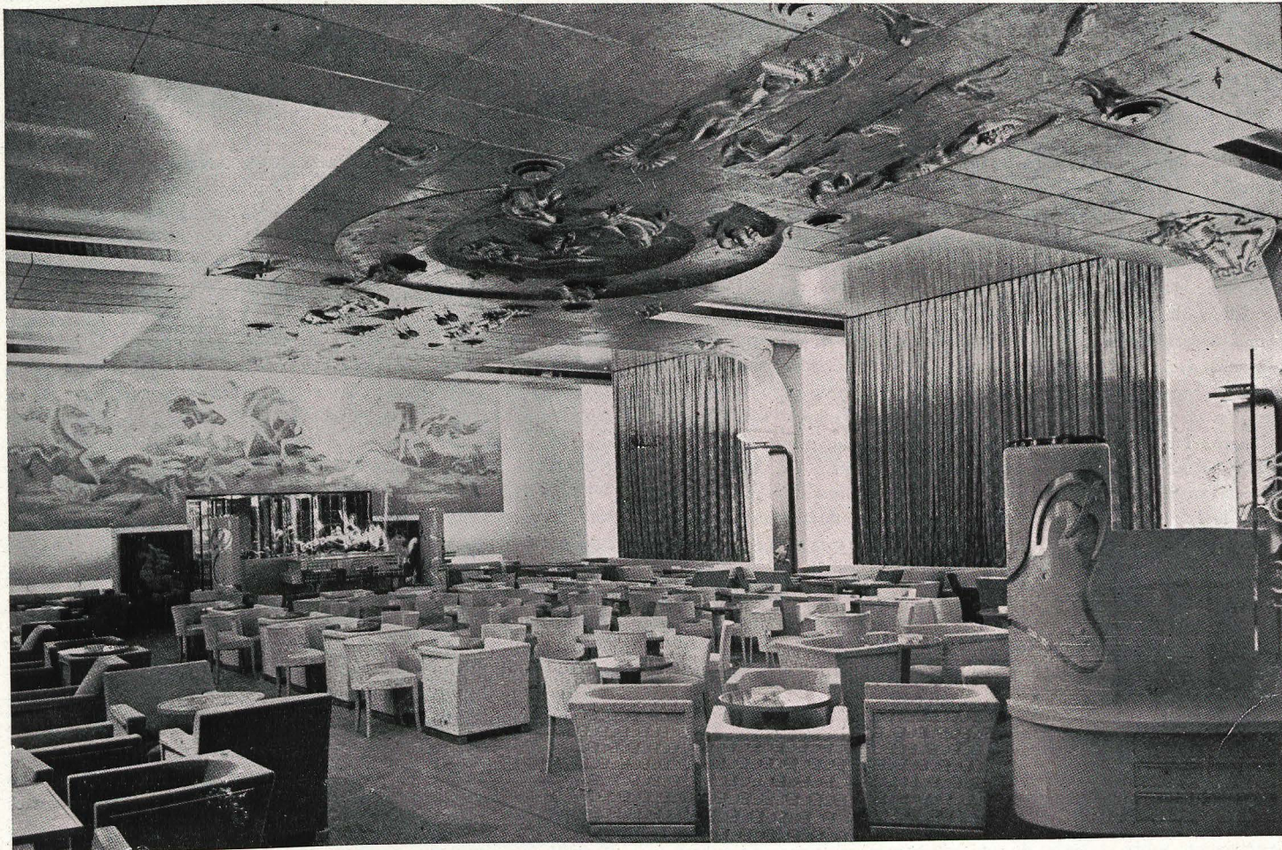
Una interesante posibilidad de alumbrado interior. Espejos en cúpula están aquí iluminados por lámparas tubulares dispuestas en líneas. Estas lámparas no están totalmente disimuladas intencionadamente, para que el alumbrado permanezca parcialmente directo.
