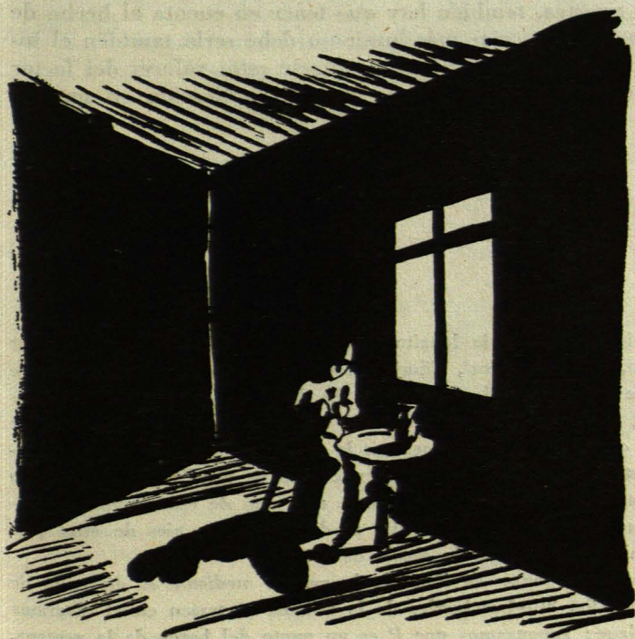
Figura 4.—Efecto de contraste entre la ventana y las paredes mal iluminadas. Iluminación deficiente, deslumbramiento y fatiga para el ojo.
