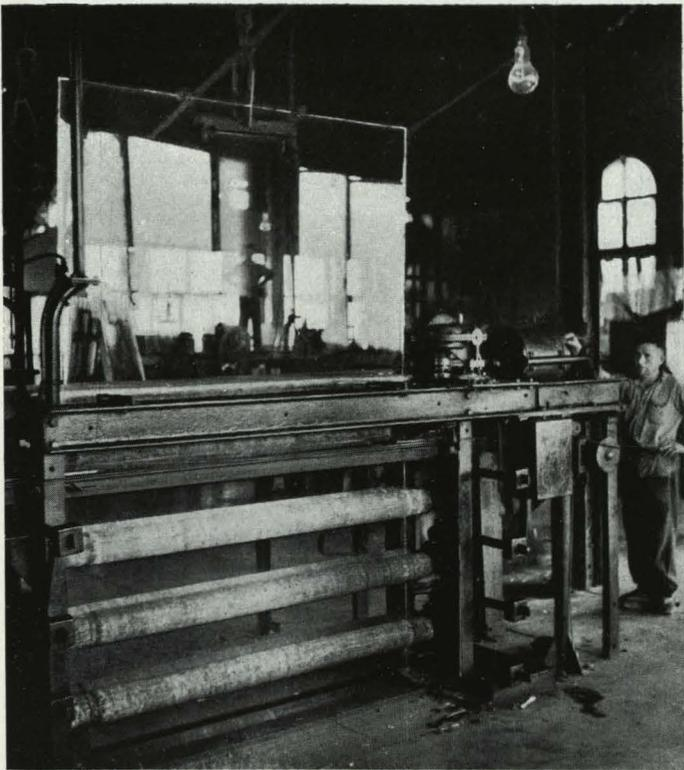
*La hoja de vidrio, recién fabricada, sale ininterrumpidamente por cada una de las siete máquinas del horno, a velocidad variable, desde 0,30 metros a 1,20 metros por minuto, cortándose las hojas en altos hasta de tres metros.*
