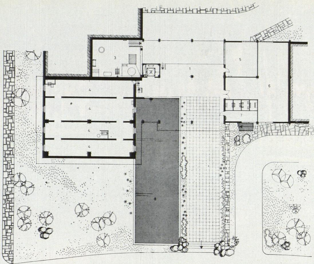
PLANTA BAJA: 1. Muelle de descarga.—2. Montacargas.—3. Calderas.—4. Instalaciones y conducciones visitables.—5. Carbónico.—6. Almacén.—7. Transformadores.—8. Estanque.
