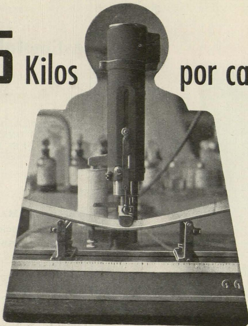
**La resistencia a flexión del TABLEX EXTRADURO alcanza una carga de rotura de 795 Kilos por cm.<sup>2</sup>**
