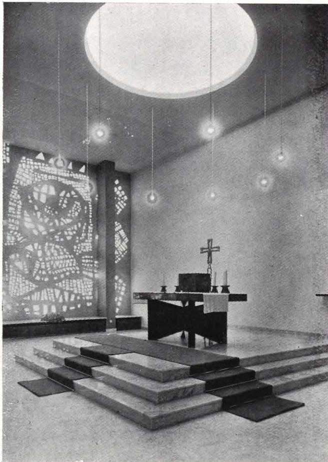
A causa de su situación y de estar sus dos testeros ciegos, este salón sólo recibe luz por una de sus caras, en la cual se ha ejecutado una vidriera artística de hormigón armado de tres centímetros de espesor, realizada en Berlín según diseño del señor Paul Corazzolla.
