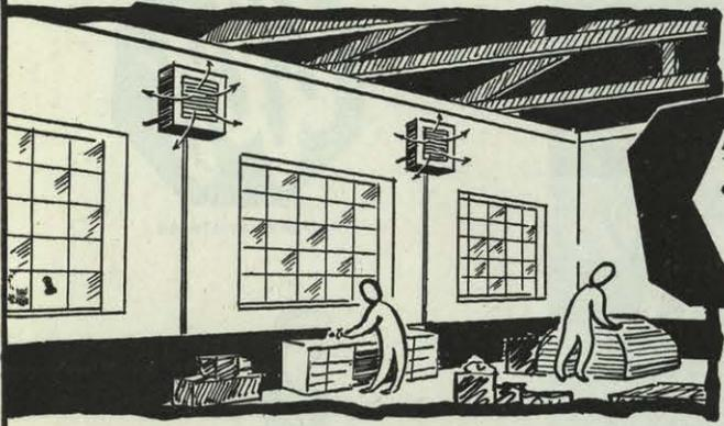
**Aerocalentadores,** elemento de calefacción empleado para calentar amplios locales de trabajo.
