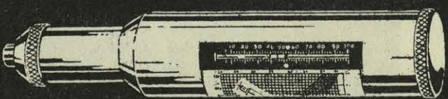
Aparato que permite examinar en muy breve tiempo la calidad y resistencia del hormigón realizado en la obra. Así como la marcha de endurecimiento para decidir el desencofrado.
