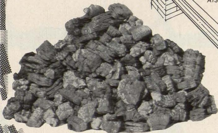
El HORMIGON-TERMITA se obtiene mezclando TERMITA granular con cemento y agua, como si se tratara de formar un hormigón corriente
