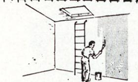
**Para impermeabilizar depósitos de agua potable** por no ejercer ninguna acción sobre ella. (Emplear el Aquaseal N.º 5). Previamente hay que efectuar una cuidadosa limpieza del interior de los depósitos, y reparar las fisuras o grietas si las hay.
