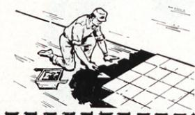
**Para embaldosado de terrazas.** El Aquaseal N.º 5 mezclado con arena (1:3 en volumen) da un mortero asfáltico muy elástico, adherente e impermeable ideal para el embaldosado de terrazas.
