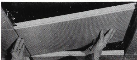
Sección de un panel con el aislamiento termo-acústico de gran poder absorbente, recubierto con una lámina de papel aluminio
