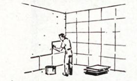
**Para adherir placas de corcho u otras piezas aislantes en cámaras frigoríficas,** aplicando la pasta Aquaseal a estas piezas por medio de una espátula y colocándolas a continuación, presionando un poco. (Emplear el Aquaseal N.º 1 como pegamento y Vaporseal como barrera de vapor).
