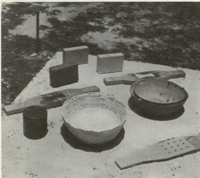
Azufre usado como impermeabilizante de madera, en la fabricación de recipientes para agua.
