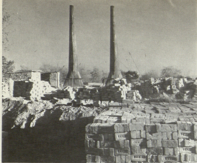
India. Chimeneas móviles para fabricación de ladrillo.
