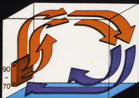
Temperaturas demasiado altas. Circulación de aire demasiado importante. Reparto irregular de temperatura
