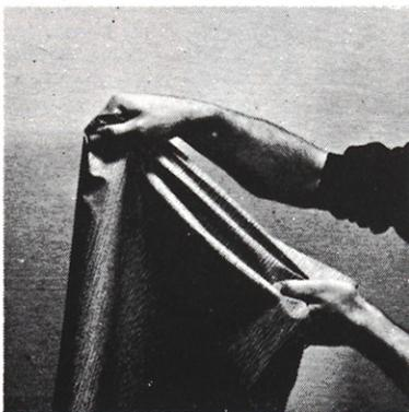
La resistencia y flexibilidad del conjunto "tejido-capa de vinilo" hace que el revestimiento se adapte a los eventuales movimientos de los paramentos, manteniendo este comportamiento por tiempo indefinido, incluso en paramentos y techos continuos de escayola.
