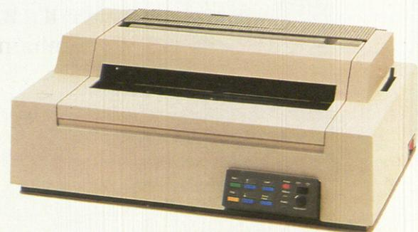
*La Impresora IBM Wheelprinter utiliza margaritas de caracteres, contenidas en plástico protector para mayor duración y limpieza de uso.*
