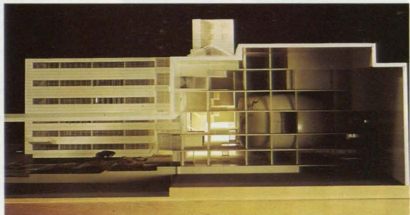
Sección de la maqueta en la que se aprecia la inserción del nuevo salón de actos (en forma de cráneo) en la trama reticular de la estructura.
