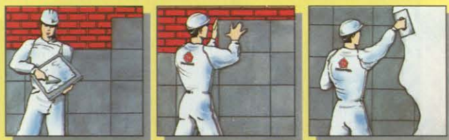
Aislamiento de muros
