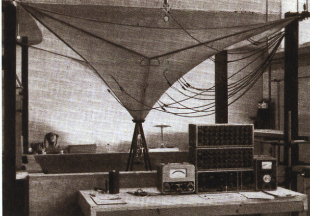
15 · ENSAYO REALIZADO POR HOSSDORF SOBRE MODELO DEL MÓDULO PABELLÓN EXPO-64 LAUSANA. ESCALA 1:60
