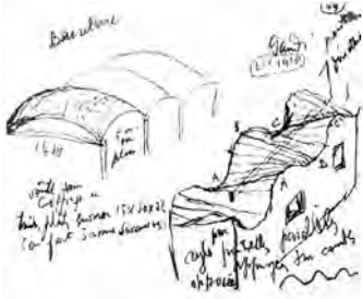
Fig. 114. Le Corbusier. Análisis sobre la geometría y sistema constructivo de las bóvedas tabicadas de las escuelas de la Sagrada Familia.
