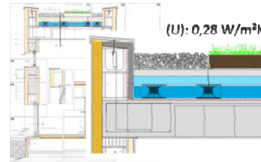
1.3 Cubierta ajardinada con aljibe
