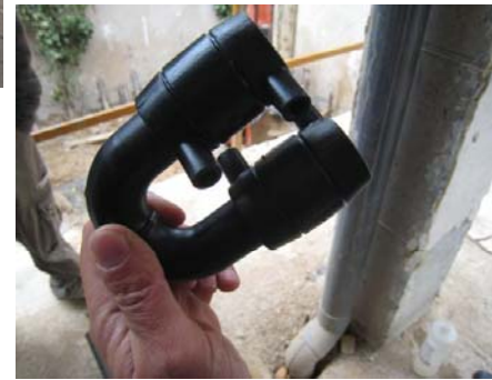
Piezas soldadas por termofusión
