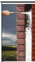
Inyección para relleno de cámara de aire.
