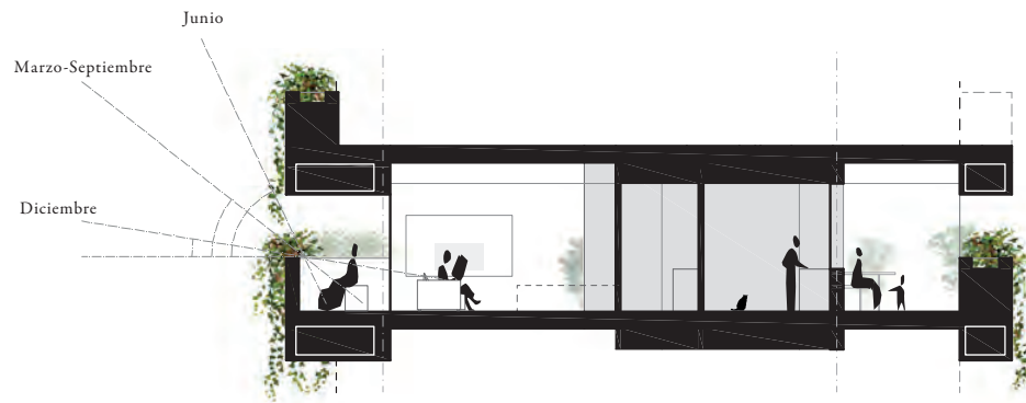
SECCIÓN TRANSVERSAL UNIDAD DE VIVIENDA
