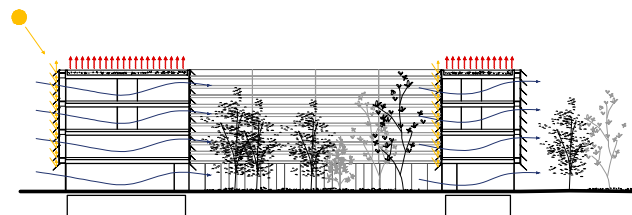
Radiación solar y ventilación en verano
