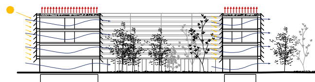
Radiación solar y ventilación en invierno
