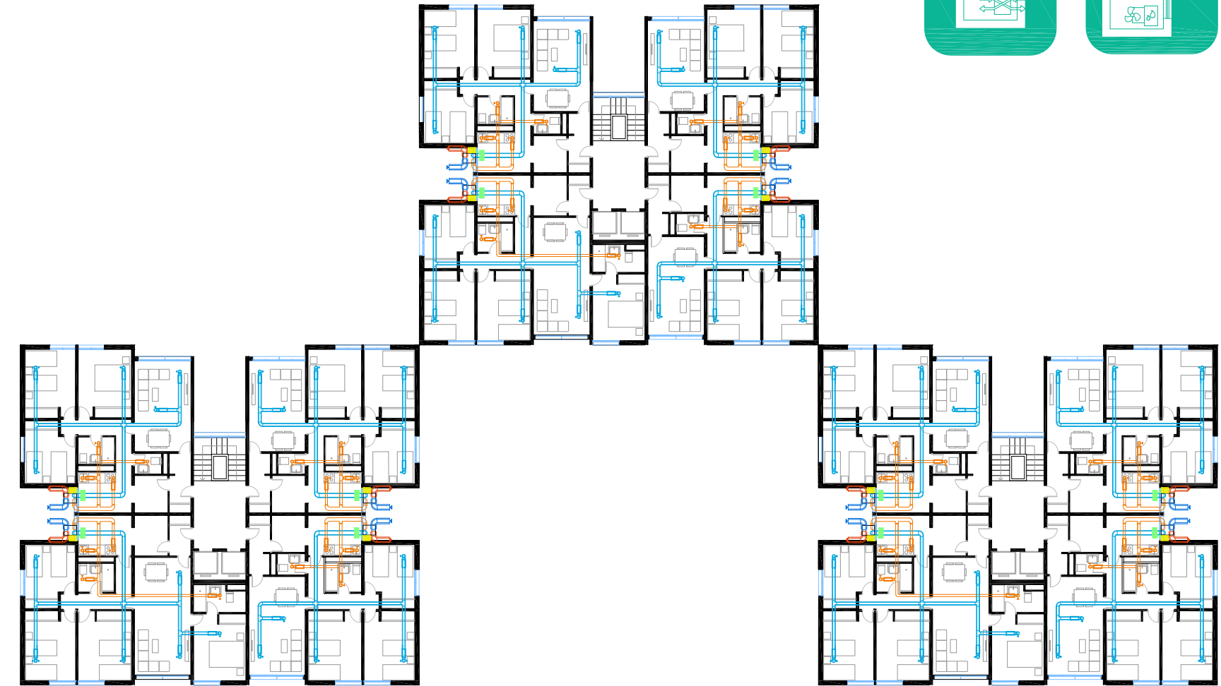
PLANTA VENTILACION MECANICA TIPOLOGIA TORRE ESCALA 1/300 PASO 2-3
